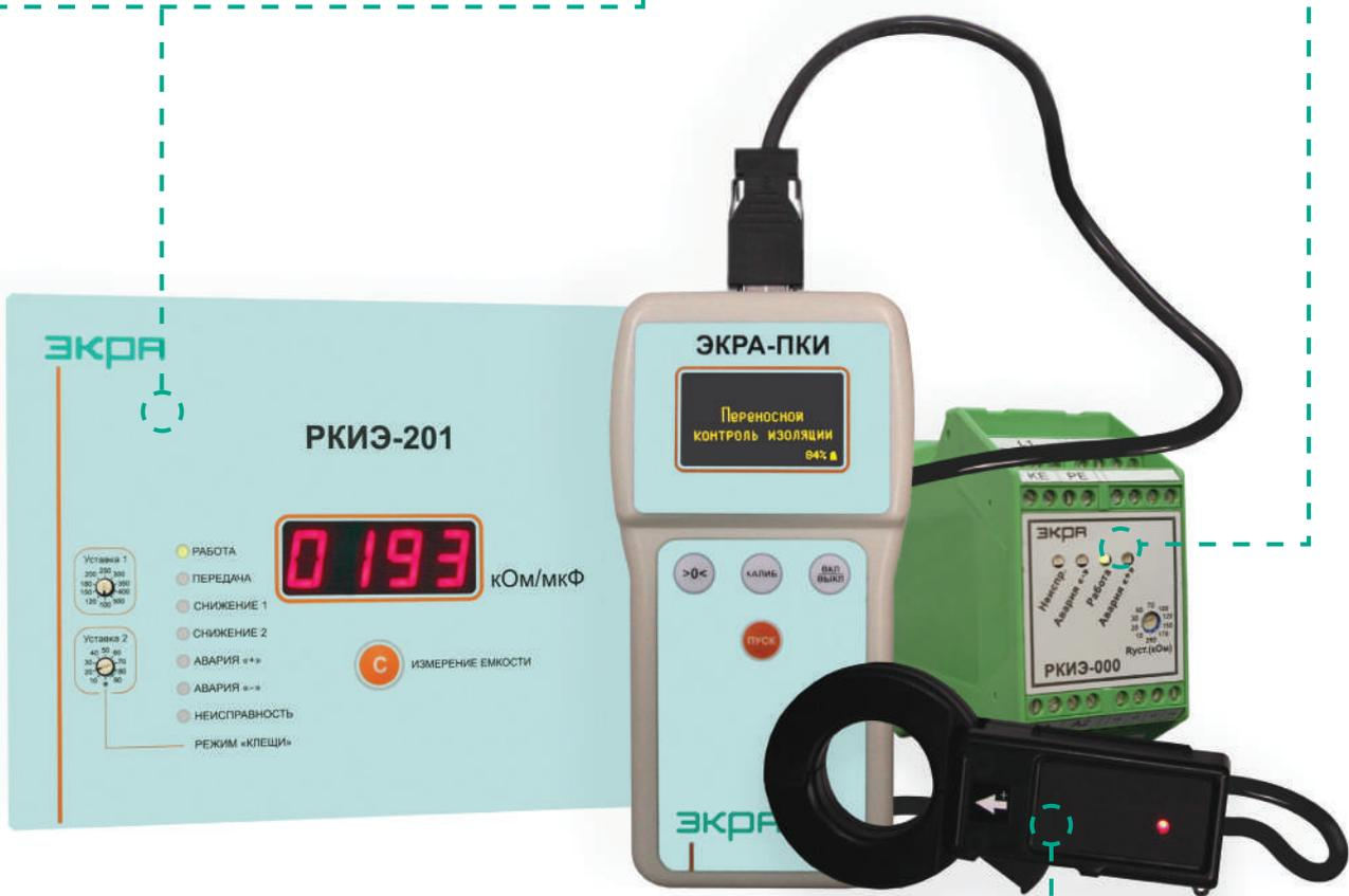
Конструктивно переносное устройство ЭКРА-ПКИ выполнено в виде измерительного блока с присоединенными к нему токовыми клещами для обхвата положительного и отрицательного проводов присоединения. Результат полного сопротивления изоляции и полярность поврежденного провода выводится на дисплей.
